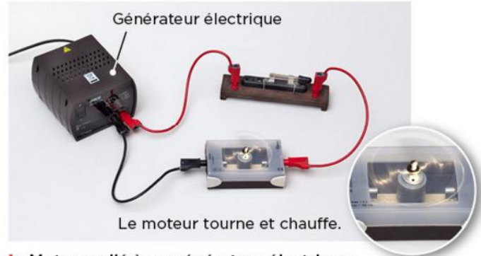
b. Moteur relié à un générateur électrique.
